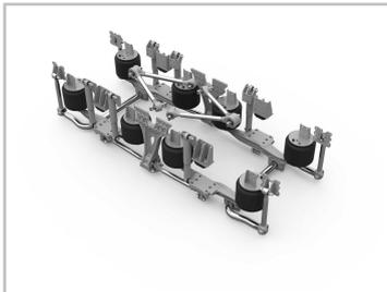
Luftgedertes Lkw-Hinterachssystem ZF Airtac.
