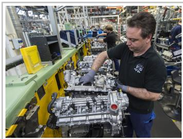
Montage des V6-Dieselmotors OM642 im Mercedes-Benz-Werk Berlin.
