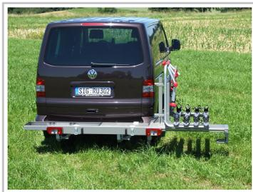
Verschieb- und schwenkbarer Heckträger von Buck.
