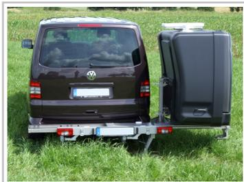
Verschieb- und schwenkbarer Heckträger von Buck.
