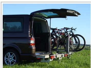
Verschieb- und schwenkbarer Heckträger von Buck.
