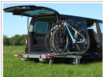
Verschieb- und schwenkbarer Heckträger von Buck.
