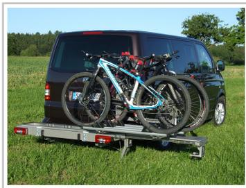
Verschieb- und schwenkbarer Heckträger von Buck.
