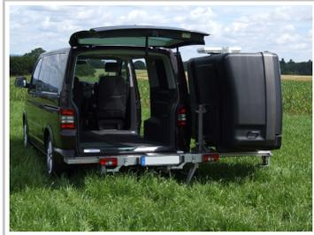
Verschieb- und schwenkbarer Heckträger von Buck.
