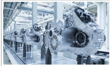
Produktion des Doppelkupplungsgetriebes DQ 200 im Skoda-Werk Vrchlabí.
