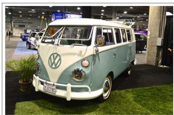
Von Zelectric Motors auf Elektroantrieb umgebauter VW Bus von 1964.
