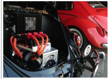
VW Käfer von Zelectric Motors: Elektromotor statt luftgekühlter Vierzylinder im Heck.
