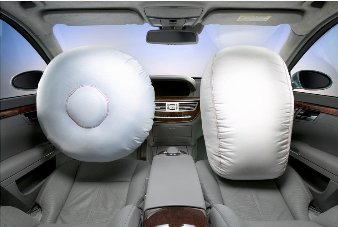
Airbags in einer Mercedes-Benz S-Klasse der Baureihe W 221 (2005).
