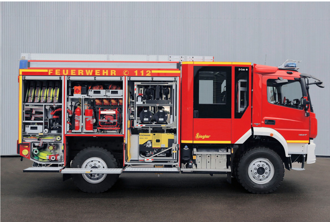
Löschgruppen-Fahrzeug Mercedes-Benz Atego 1323 AF 4x4 Euro VI mit einem Aufbau vom Typ LF 10 KatS der Firma Ziegler.
