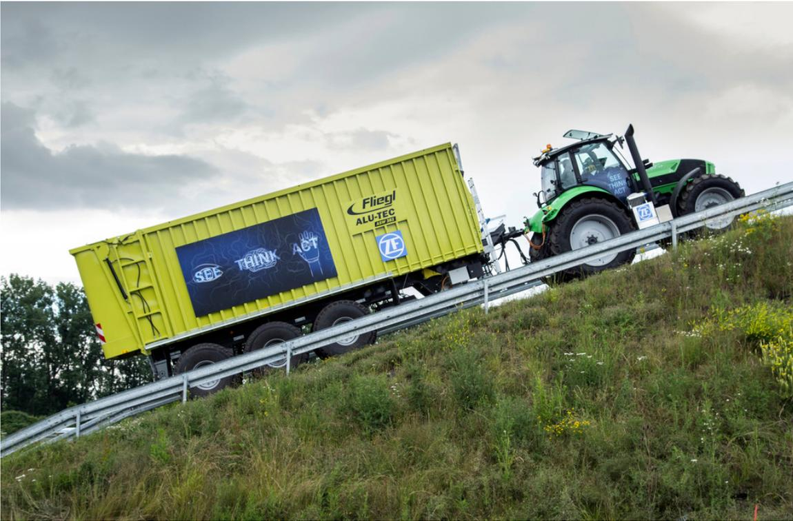
ZF Innovation Tractor: Das Gespann schafft nur mit dem elektrischen Zusatzantrieb im Anhänger 30 Grad Steigungen.
