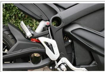
Zero S ZF 13.0 mit 11 kW: Leichtbau durch Hohlräume.
