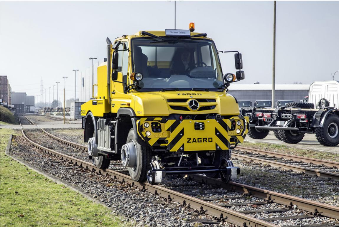
Mercedes-Benz Unimog für die Schiene.
