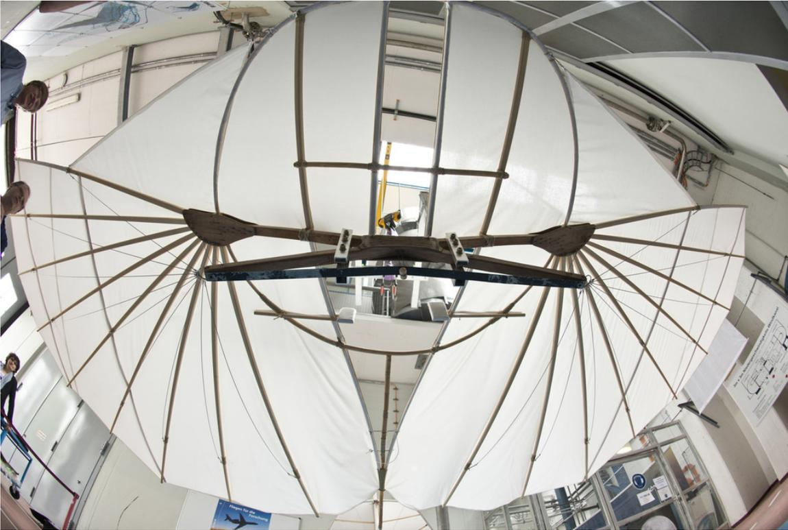
Der Lilienthal-Nachbau nach dem Original aus dem 19. Jahrhundert besteht aus einem Leichtholz und einer Bespannung mit Baumwollstoff. Bei einer Flugspannweite von 6,70 Metern wiegt er rund 20 Kilogramm.
