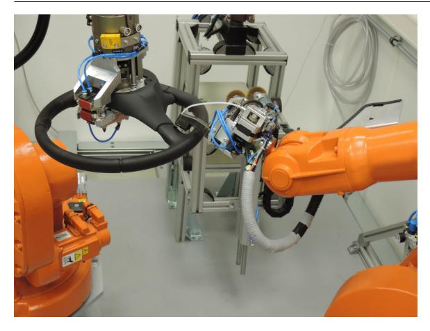
Bei der Produktion von Lenkrädern mit der CHIS-Heiztechnologie (Conductor Insert Heating System) verwendet ZF TRW eigene Werkzeuge.
