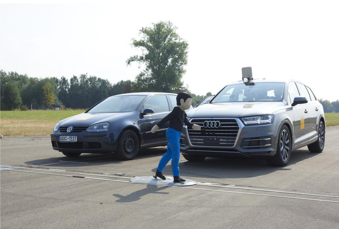
Der ADAC hat eine Anlage zum Test von Notbremsassistenten.
