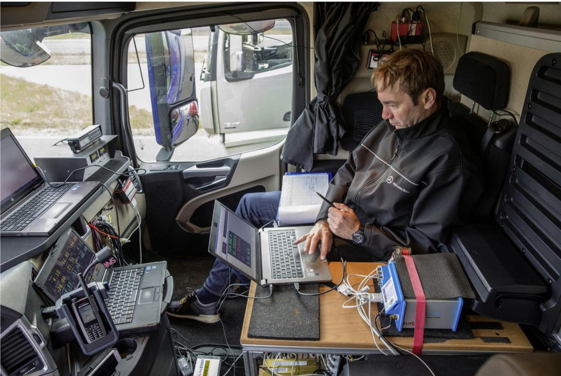
„Efficiency Run“: Bei den Testfahrten führte ein Dekra-Ingenieur Protokoll.
