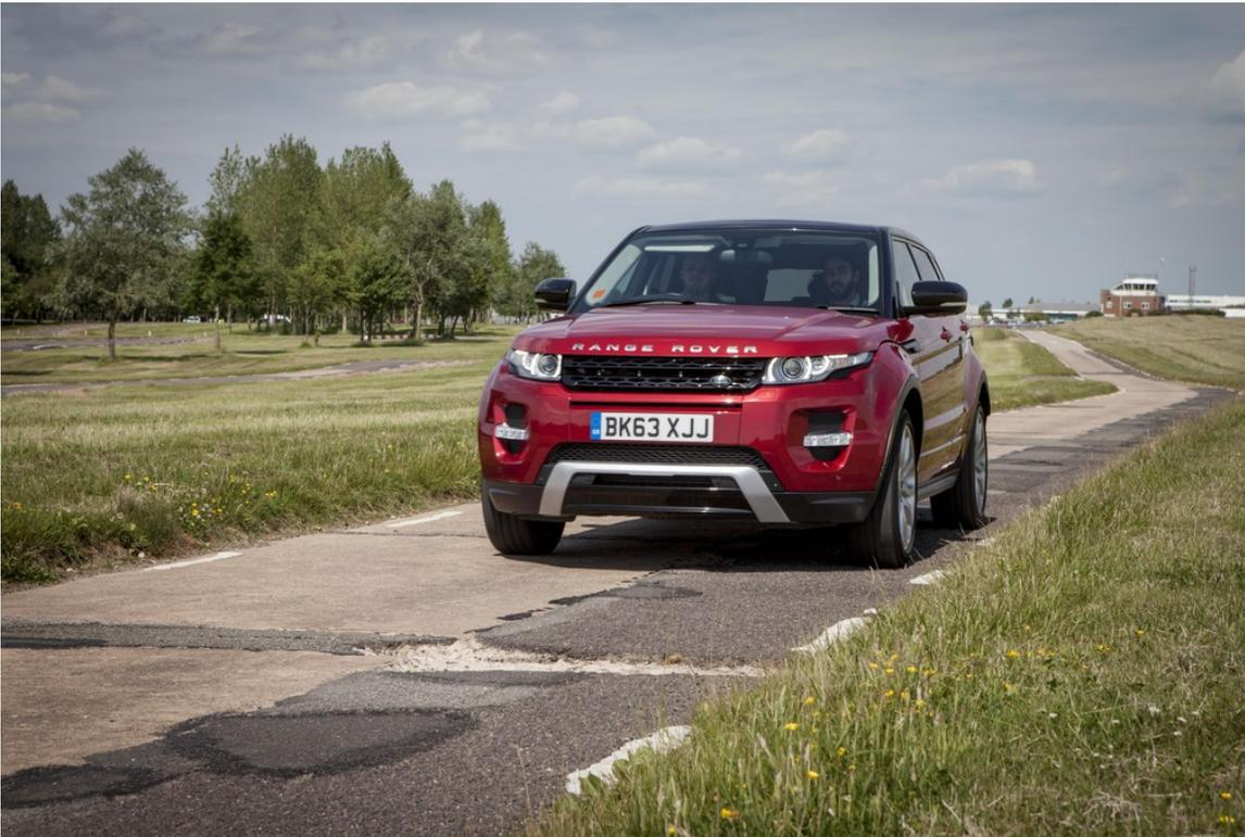
Im JLR-Test- und Entwicklungszentrum Gaydon: Ein Range Rover Evoque erfasst den Fahrbahnzustand und erkennt Fugen, Unebenheiten und Schlaglöcher.
