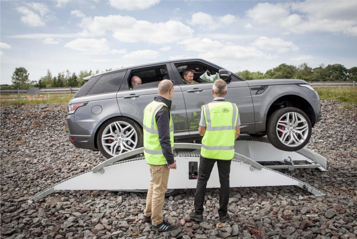
Im Test- und Entwicklungszentrum Gaydon arbeitet Jaguar Land Rover an Aspekten automatisierten Fahrens: Ein Range Rover wird per Smartphone von außen im Schrittempo über ein Hindernis geführt.
