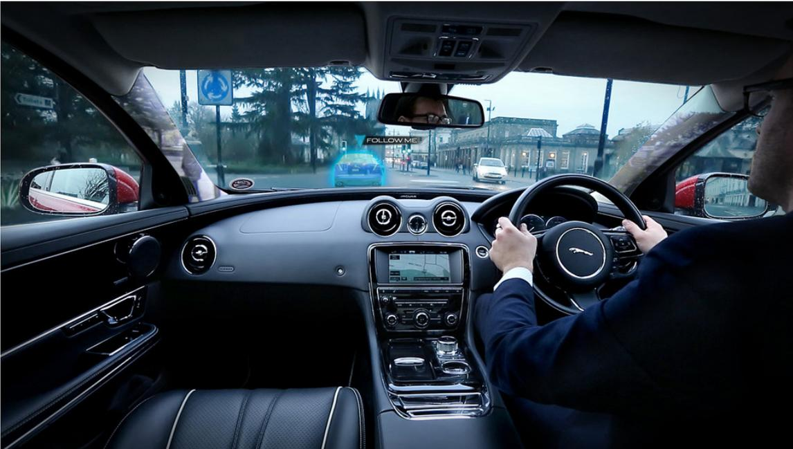
Jaguar Land Rover entwickelt Technologien, die die Dachsäulen des Fahrzeugs dank Kamera transparent erscheinen lassen und bei der Navigation ein virtuelles Vorfahrzeug in das Head-up-Display ein spiegeln. Die Systeme werden „360 Virtual Urban Windscreen“ und „Follow-Me Ghost Car Navigation“ genannt.
