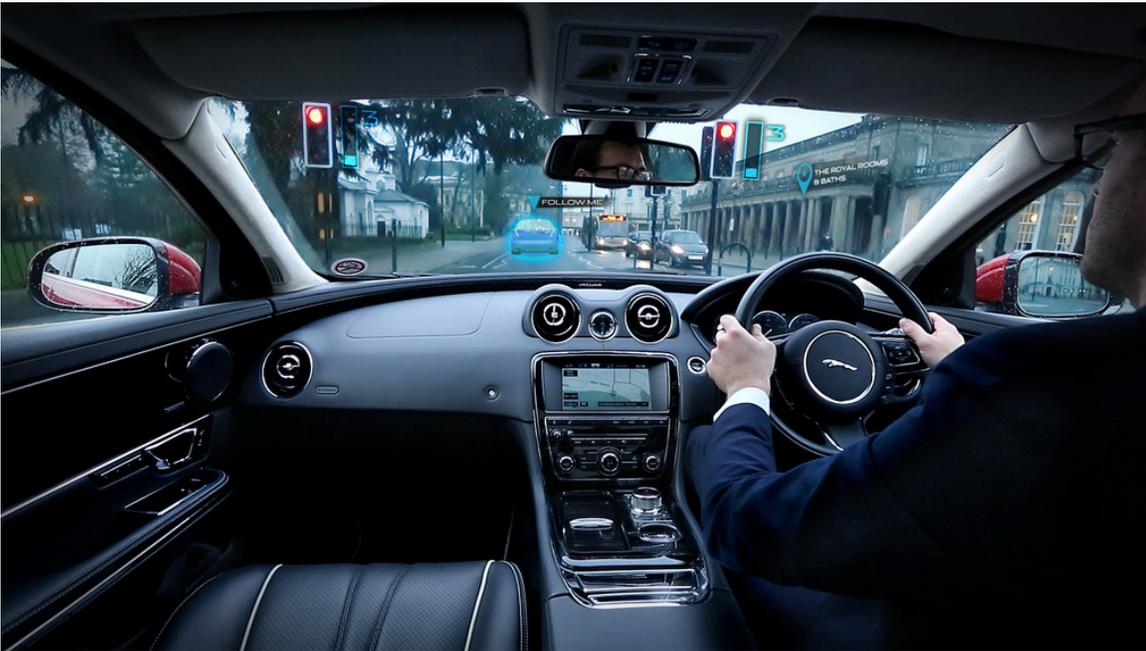
Jaguar Land Rover entwickelt eine Technologie, bei der das Navigationssystem ein virtuelles Vorausfahrzeug in das Head-up-Display einspiegelt („Follow-Me Ghost Car Navigation“).
