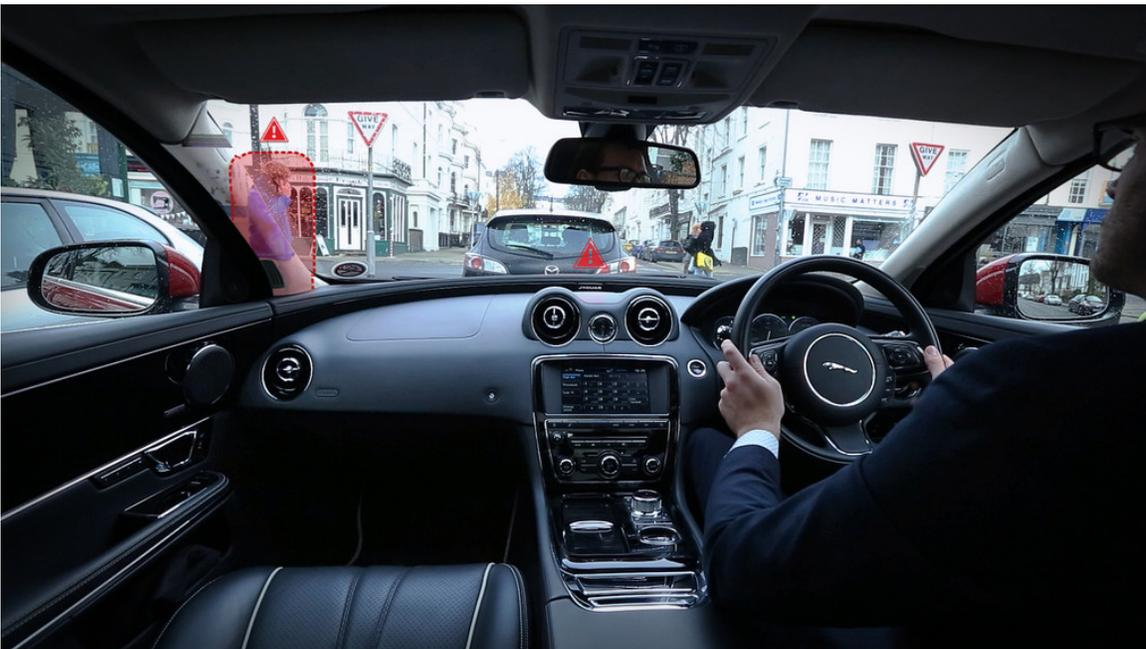
Jaguar Land Rover entwickelt eine Technologie, die die Dachsäulen des Fahrzeugs dank Kamera transparent erscheinen lassen („360 Virtual Urban Windscreen“).
