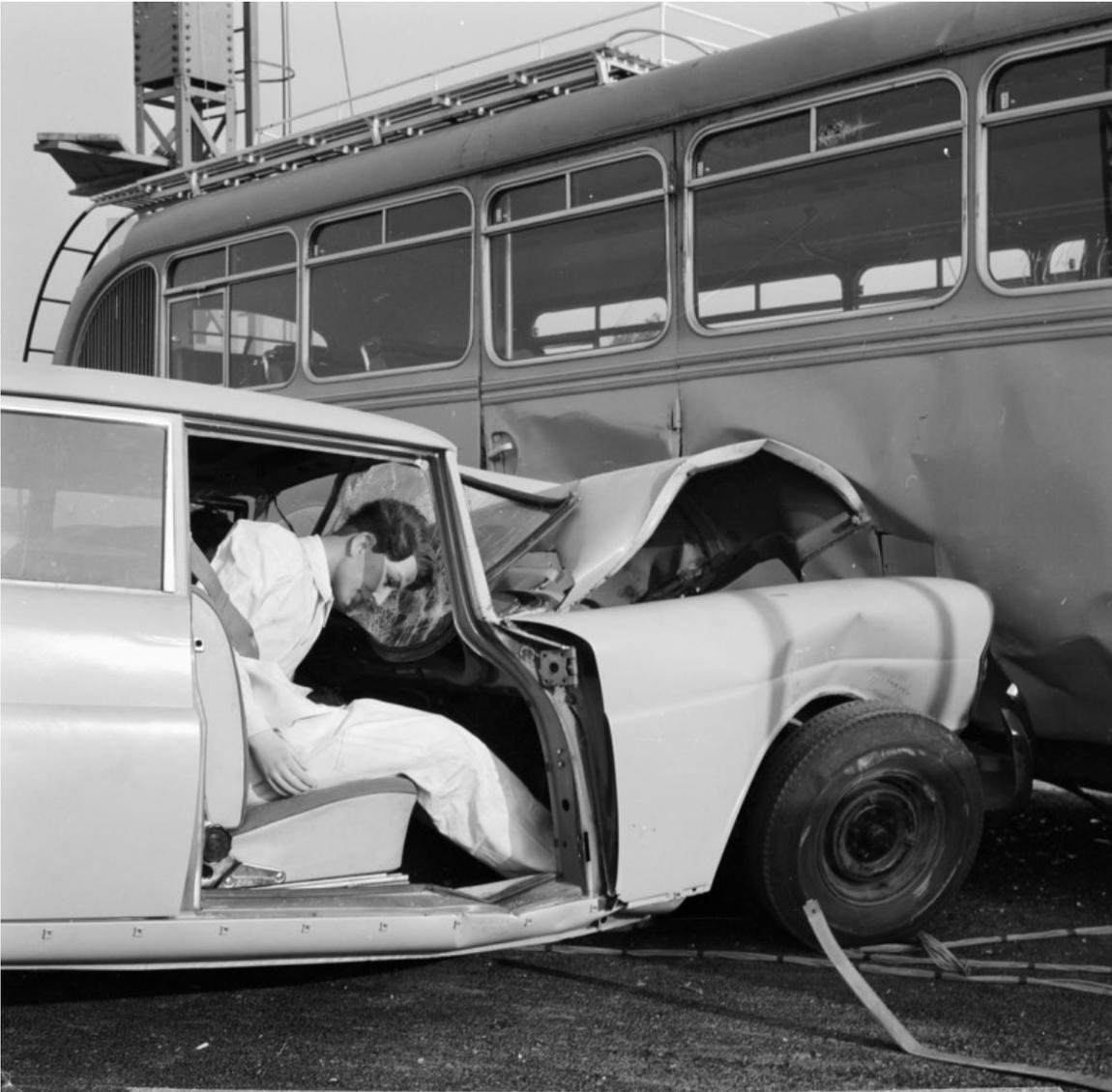
Aufprallversuch im Mercedes-Werk Sindelfingen mit einem Typ 220 Sb mit einer Geschwindigkeit von 86 km/h auf einen Omnibus (1962). Die Oberklasse-Baureihe W 111 (1959 bis 1965) war das weltweit erste Fahrzeug mit Sicherheitskarosserie.
