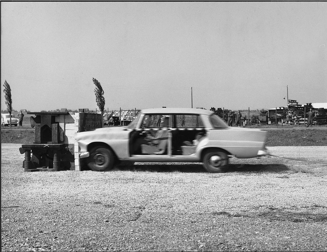
Mit dem Frontaufprall eines Fahrzeugs der Baureihe W 111 begannen am 10. September 1959 die Crashtests von Mercedes Benz. Es ist das erste Automobil der Welt mit gestaltfester Fahrgastzelle und Knautschzonen an Front und Heck.
