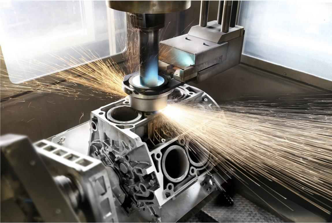
Nanoslide-Beschichtung beim Mercedes-Benz-Motor.
