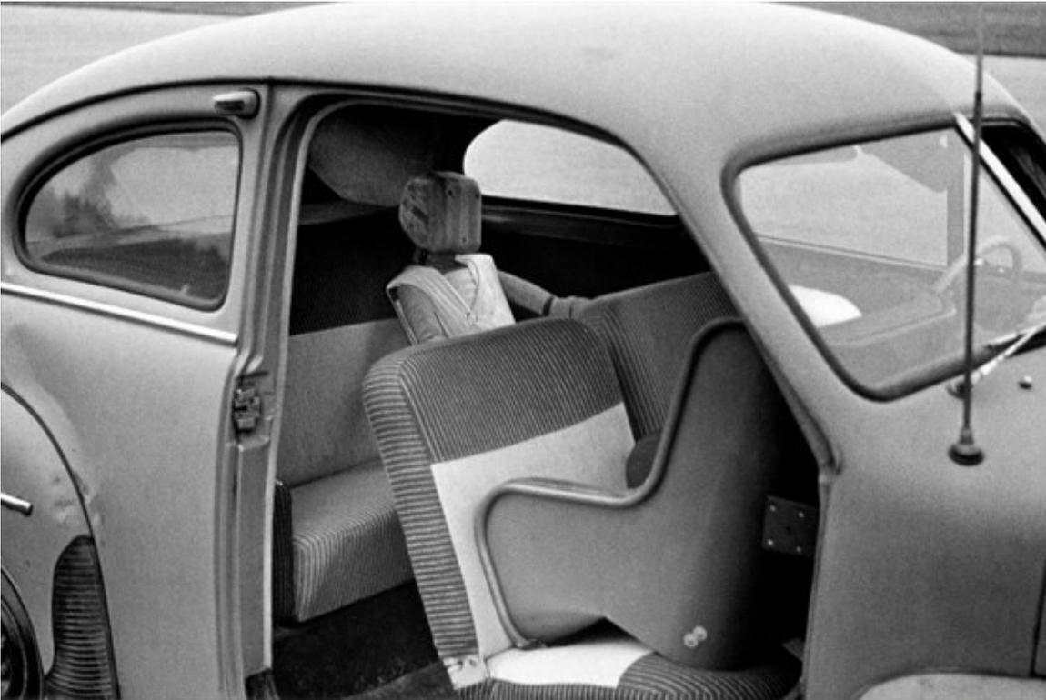
Test des Prototypen des ersten gegen die Fahrtrichtung ausgerichteten Kindersitzes im Volvo PV 444. Inspiriert von der Sitzposition von Astronauten, entwickelte Bertil Aldman, Arzt und später Professor für Verkehrssicherheit an der Technischen Hochschule Chalmers in Göteborg, den ersten Prototypen eines Kindersitzes. Volvo war eng in die Entwicklung eingebunden und testete den Sitz im PV 544.
