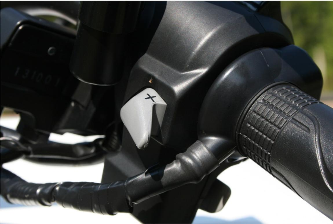
Honda CTX 700 N: Manueller Schalter für das DCT.
