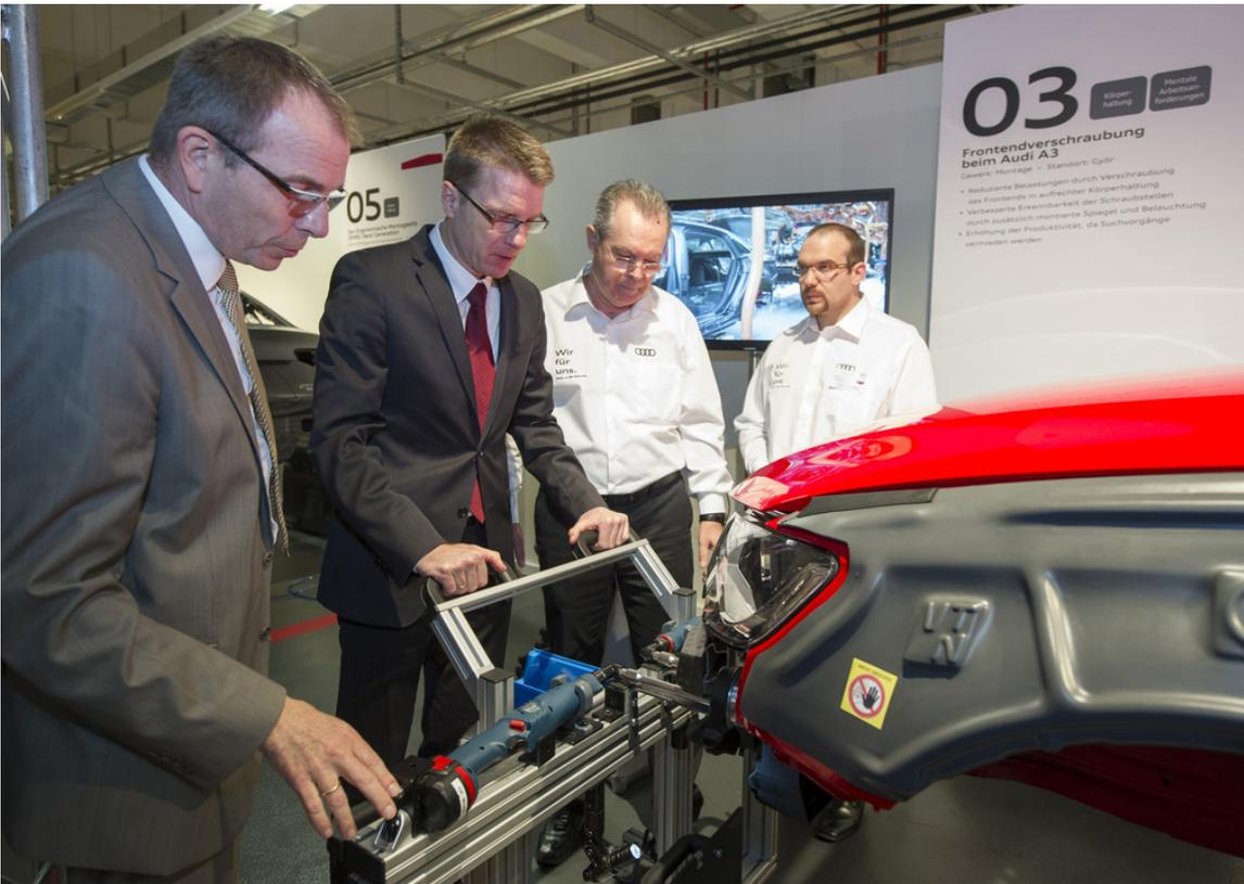
Werkleiter Fred Schulze testet das neue Werkzeug, mit dem man das Frontend des Audi A3 rückschonend montieren kann.
