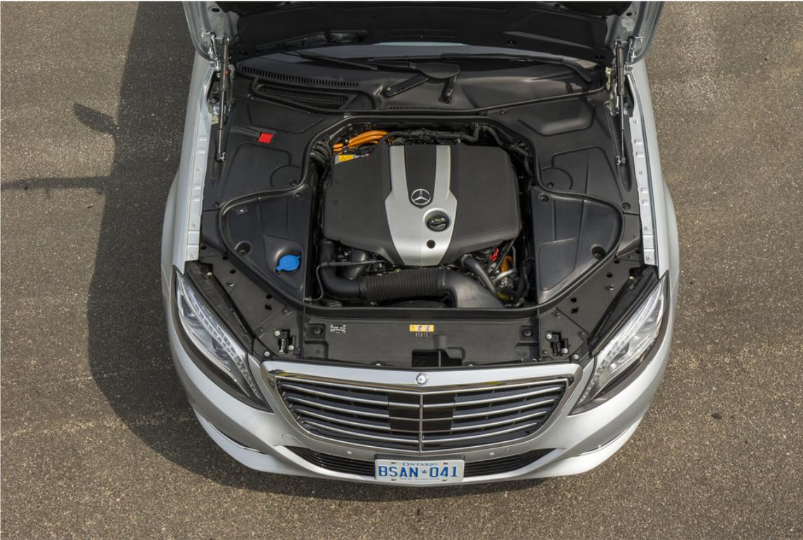
Mercedes-Benz S 300 Bluetec Hybrid mit Motorraumkapselung „Eco Thermo Cover“.
