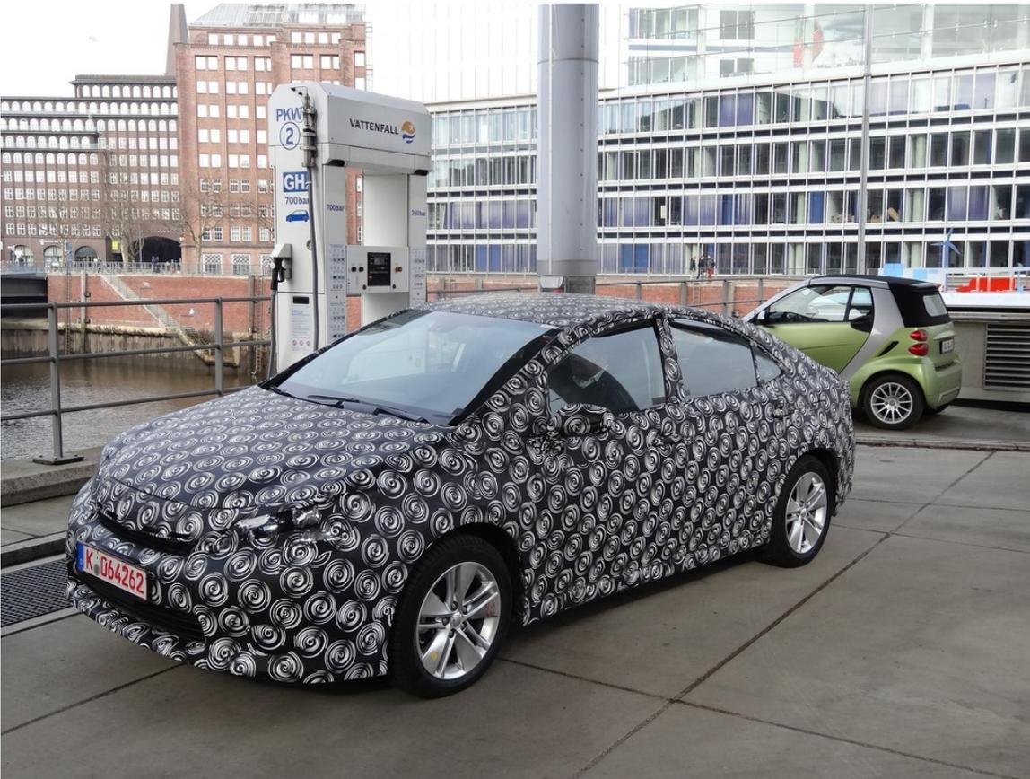
Prototyp eines Toyotas mit Brennstoffzellen-Antrieb an einer der drei Wasserstofftankstellen in Hamburg.
