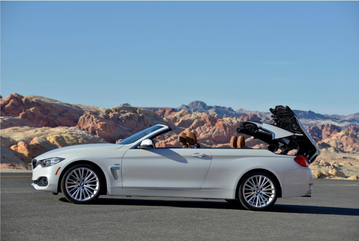
BMW 4er Cabrio: Das Verdeck öffnet in rund 20 Sekunden bei maximal 18 km/h.
