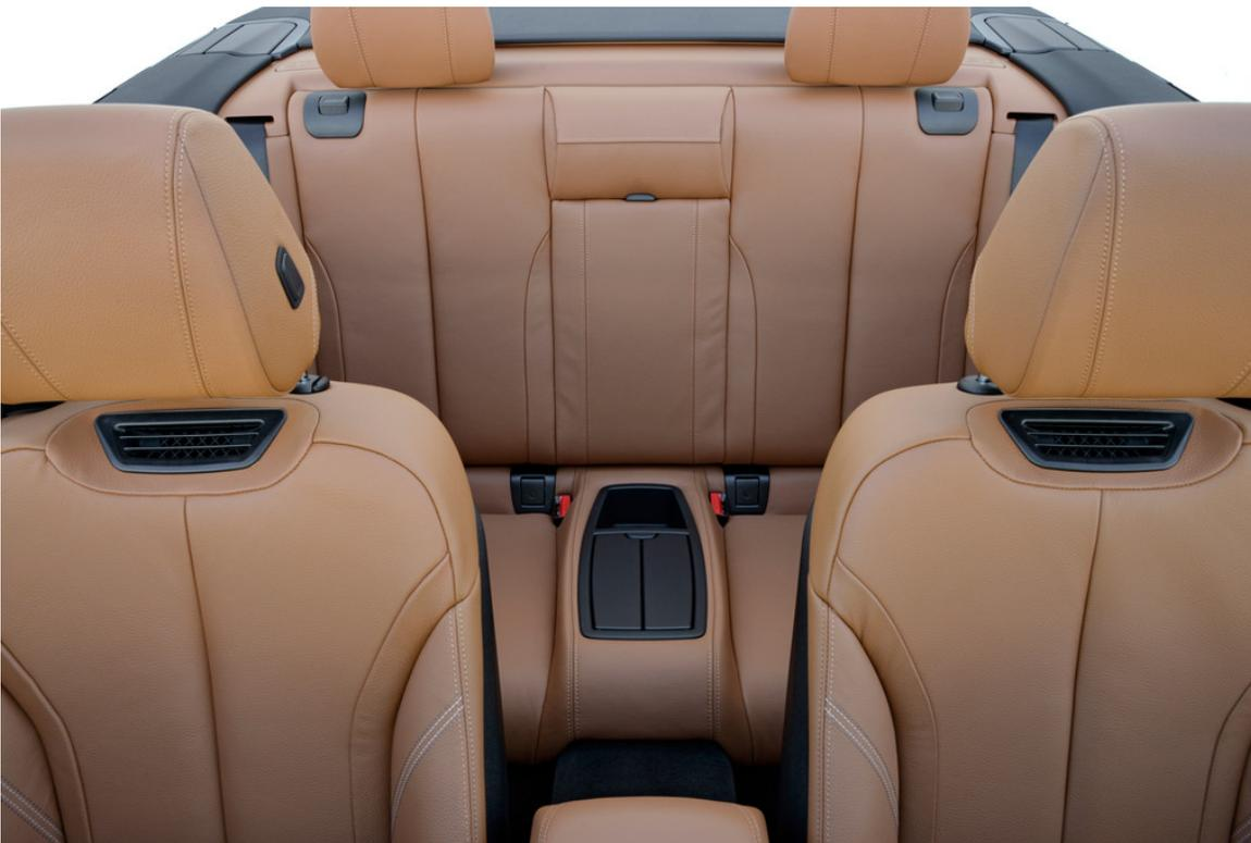
BMW 4er Cabrio: Warmluft aus dem Kopfstützen ermöglicht das Fahren auch in den Übergangszeiten.
