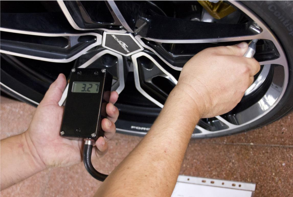
Rekordfahrten in Nardo: Der richtige Reifenfülldruck muss ständig kontrolliert und eingestellt werden und ein wichtiger Erfolgsfaktor, denn die dynamische Wärmeentwicklung bei über 300 Km/h muss für jedes Fahrzeug vorher exakt berechnet und von den Continental-Reifen-Experten freigegeben werden.
