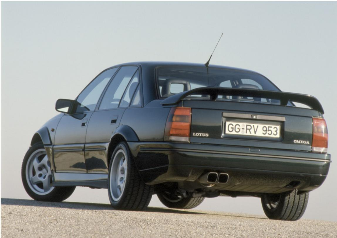
Opel Lotus Omega mit 3,6-Liter-Twin-Turbo-Motor und 277 kW / 377 PS.
