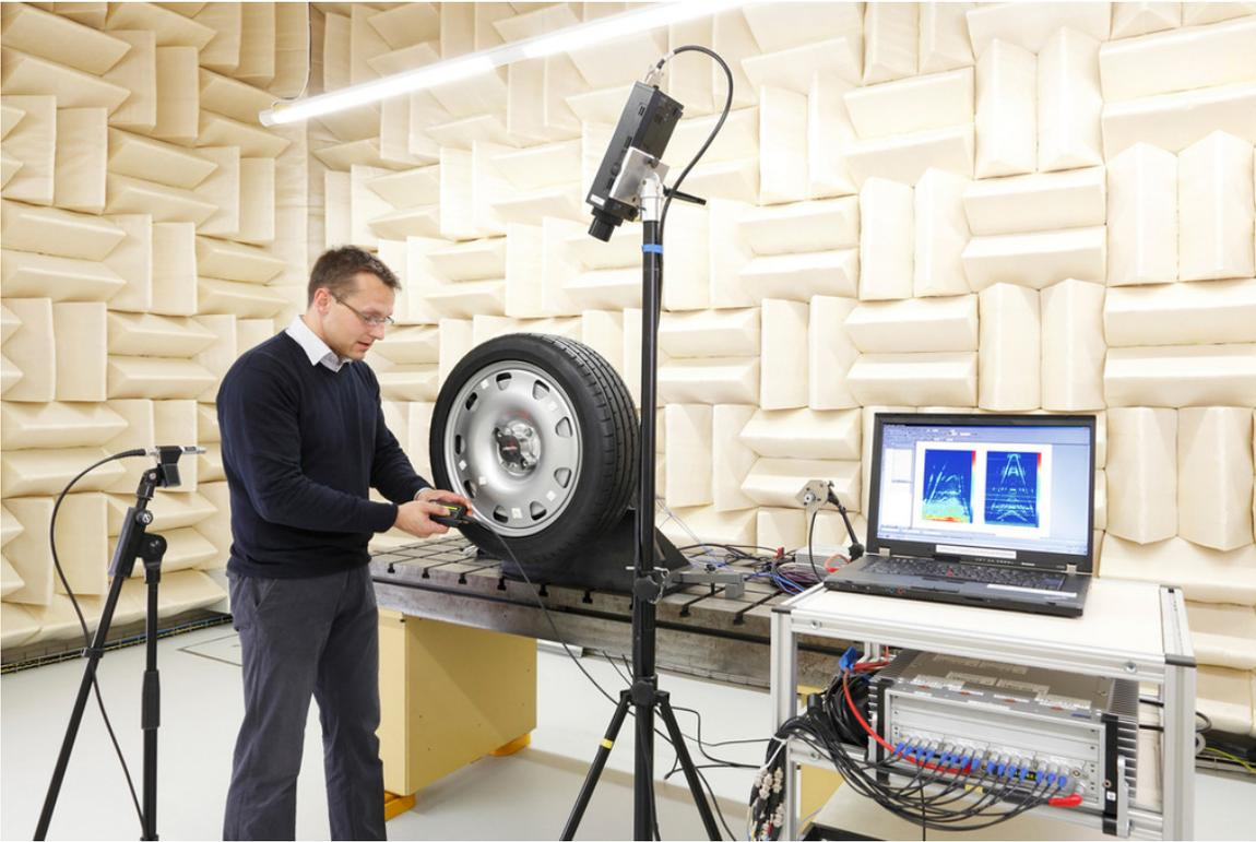
Untersuchung von Luftschall und Vibrationsverhalten eines Pkw-Radlagers im reflexionsarmen Raum bei Schaeffler.
