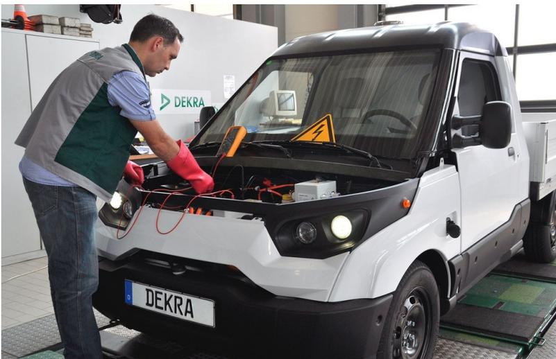
Dekra Experte Tassilo Sagawe überprüft die elektrische Sicherheit des StreetScooter.
