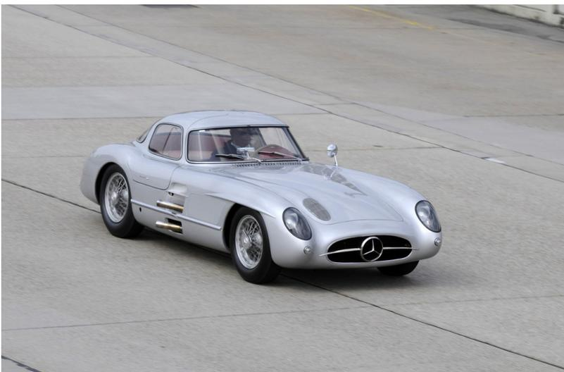
Der Mercedes-Benz 300 SLR Coupé war Mitte der 50er Jahre mit einer Höchstgeschwindigkeit von über 280 km/h das schnellste für den öffentlichen Verkehr
