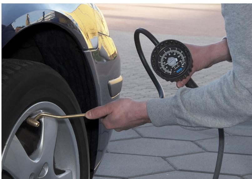
Überprüfung des Luftdrucks eines Autoreifens.
