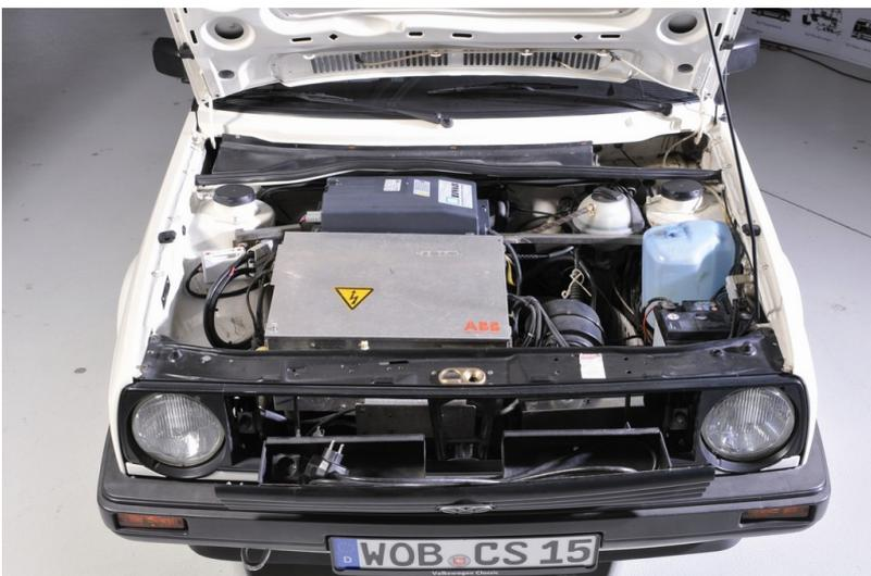
Volkswagen Golf II Citystromeo: Elektrisch mit 50 Kilometer Reichweite - eine 120 Exemplare umfassende Kleinserie von 1991 diente als Versuchsträger.
