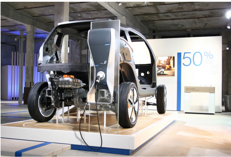
BMW i3 Concept: Fahrgastzelle aus Carbon.
