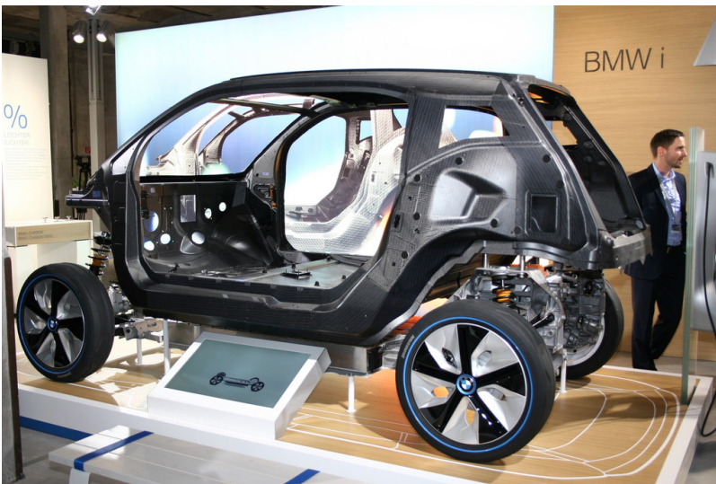
BMW i3 Concept: Fahrgastzelle aus Carbon. BMW i3 Concept; Fahrgastzelle aus Carbon.
