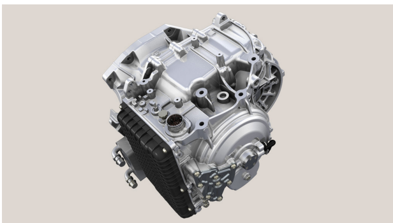
9-Gang-Automatikgetriebe von ZF.
