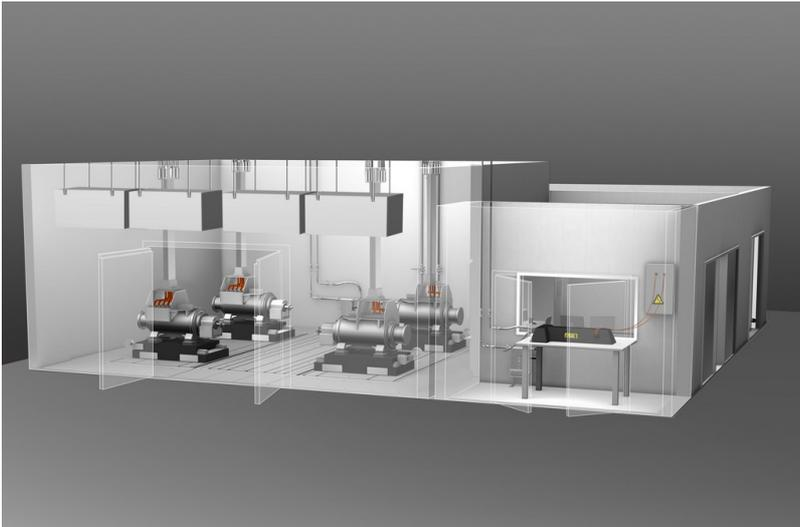
Maßgeschneidert für das Testen von Elektrofahrzeugen: Der künftige E-Drive-Systemprüfstand von „MBtech“ in der EMV-Halle Mönshheim.
