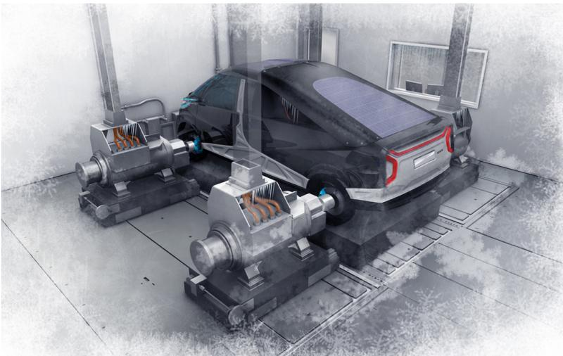
Extrembedingungen: Die Prüfkammer ermöglicht Kältetests bei einer Umgebungstemperatur von bis zu minus 30 Grad Celsius.
