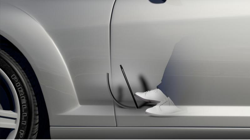
Forschungsprojekt haptisches Fahrpedal: Das Pedal kopft an, wenn Rollen die wirtschaftlichere Lösung darstellt.
