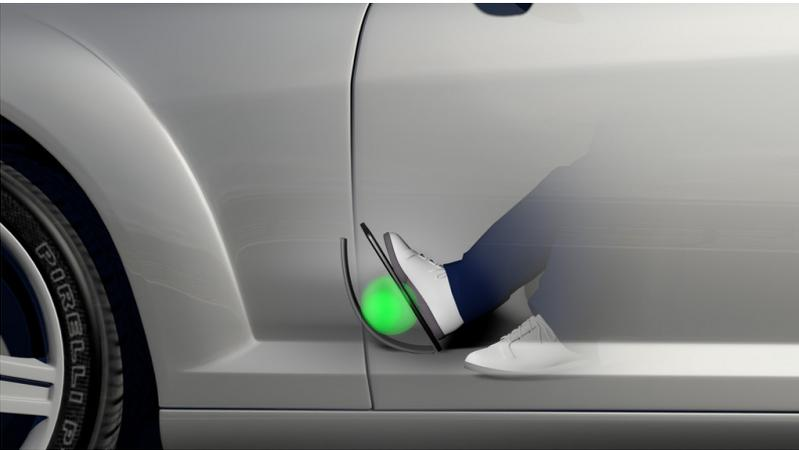
Forschungsprojekt haptisches Fahrpedal: Wirtschaftlich Beschleunigen oder über den Druckpunkt im Fahrpedal hinwegtreten und Vollgas anfordern?
