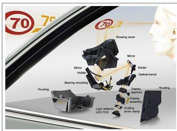
LEDs, TFT-Display und Spiegel: So ist das Continental Head-up-Display aufgebaut.
