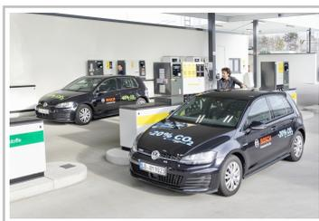
e-Fuel-Tankstelle bei Bosch. Die Fahrzeuge werden mit synthetischem Diesel mit Beimischungen von 20 Prozent und 65 Prozent e-Fuel aus normalen Tanksäulen versorgt.
