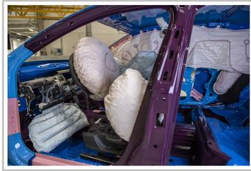
Sicherheitsforschung bei Skoda: Alle Airbags geöffnet.
