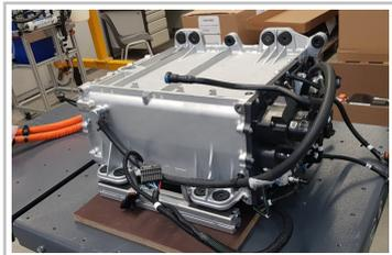
Opel Vivaro-e Hydrogen, Umrüstung bei OSV in Rüsselsheim, Brennstoffzelleneinheit.
