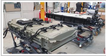
Opel Vivaro-e Hydrogen, Umrüstung bei OSV in Rüsselsheim, Batterieeinheit, Wasserstofftanks, Brennstoffzellenstack.
