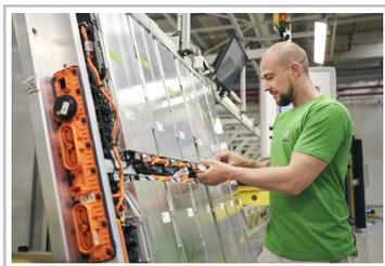
Skoda fertigt im Stammwerk in Mladá Boleslav Batteriesysteme für Elektrofahrzeuge auf Basis des Modulare Elektrifizierungsbaukastens (MEB) aus dem VW-Konzern.
