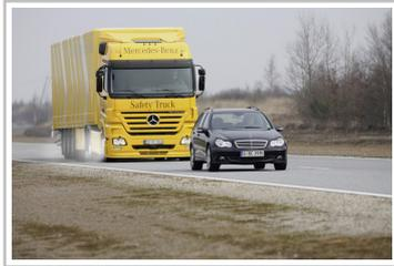
Test eines Notbremssystems für Lkw (Archivbild).
