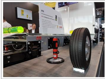
Automatische Nivellierwaage von Al-Ko für Wohnmobile.
