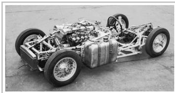
Die Basis des Skoda 1100 OHC Coupé bildete ein leichter und steifer Gitterrahmen.
