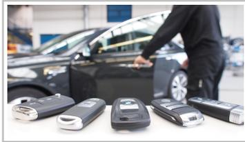
Der ADAC hat mehr als 500 Keyless-Fahrzeuge überprüft. Die meisten sind nicht gegen das Abgreifen des Funksignals gesichert.
