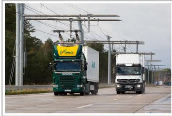
Oberleitung-Versuchsstrecke von Siemens für Hybrid-Lkw auf der A 5 bei Frankfurt.
