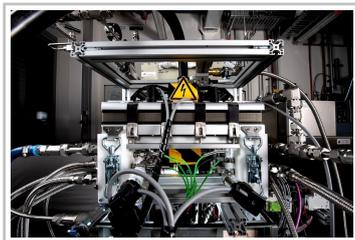
Wasserstoff-Brennstoffzelle im Labor des DLR-Instituts für Technische Thermodynamik.
