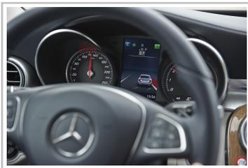
Das Fahrzeug nähert sich bedrohlich dem Fahrbahnrand. Der Spurhalteassistent wird aktiv und zeigt die Gefährdungslage an.
