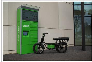
Mietfahrzeug von Greenpack an einer Akku-Wechselstation.
