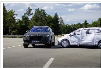
Noch leicht getarnter Mercedes-Benz S-Klasse: Wenn die Sensorik einen bevorstehenden Seitenaufprall erkennt, kann die Karosserie in Sekundenbruchteilen um acht Zentimeter angehoben werden, um steifere Elemente der Struktur zu exponieren.
