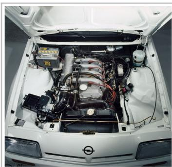
Der 144 PS starke 2,4-Liter-Vierzylindermotor mit Vierventiltechnik und zwei obenliegenden Nockenwellen des Opel Manta 400.
