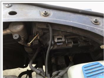
KÜS-Prüfern aufgefallen: Leuchtweitenregulierung mittels Spax-Schraube aus dem Heimwerkermarkt.
